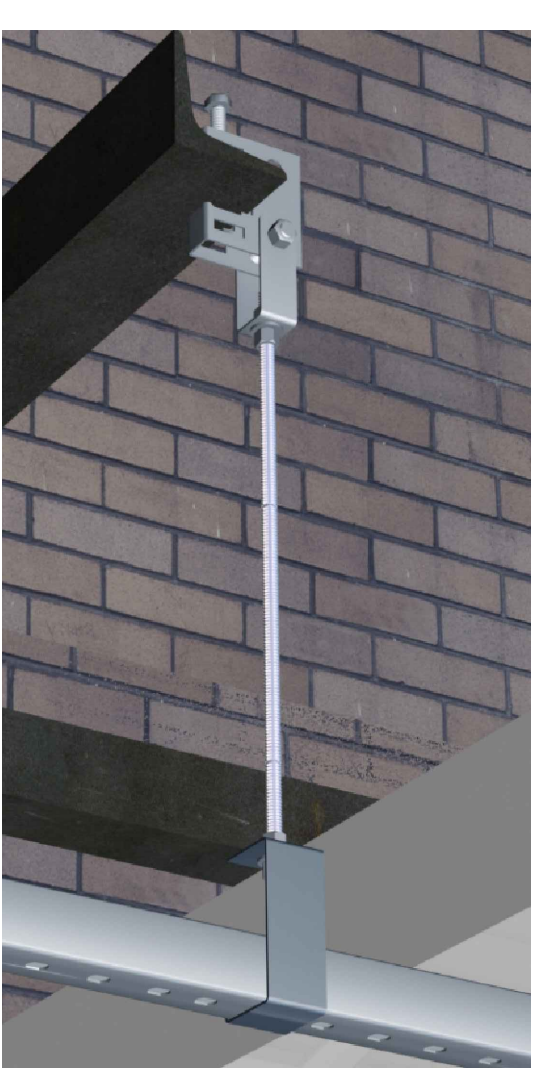
08 DETALHE FIXAÇÃO PERFILADO SEM ESCALA
